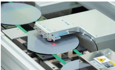
公司始终严格规范和实施制造车间现场 6S 管理，从而减少车间的人、物料、机器设备等时间与空间上的浪费。为满足下游企业对晶圆片平坦度、翘曲度、厚度、表面金属等各项指标的不同生产需求，产品在多道加工流程后需进行参数检测，以确保品质可靠。
