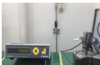
用于检测切片后 wafer 的厚度
