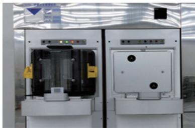
用于 wafer 的气孔检查
